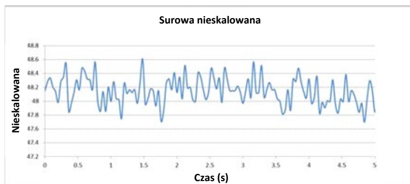
Rysunek 3: Przebieg surowego nieskalowanego sygnału wilgotności w przepływającym materiale
