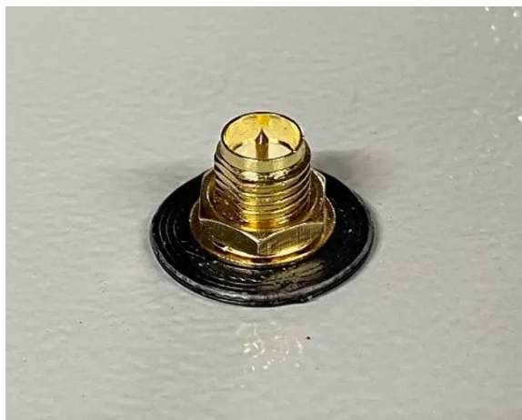
Figura 9: Cable de extensión de antena instalado
