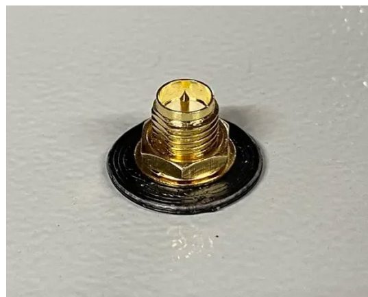
Figure 9 : Câble d'extension de l'antenne installé
