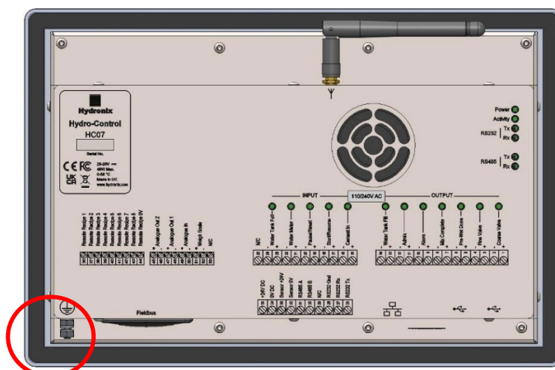
Figure 1 : Emplacement de mise à la terre de protection
